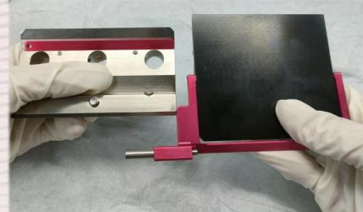
步骤五：将分开的刀夹座与压刀板分别进行清洁护理。
