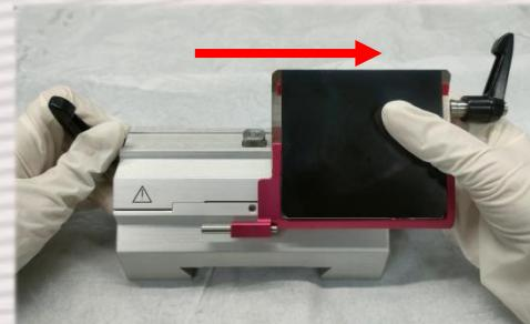
步骤二：握住刀夹座主体，向右轻轻滑出，使刀架底座与刀架分离。
