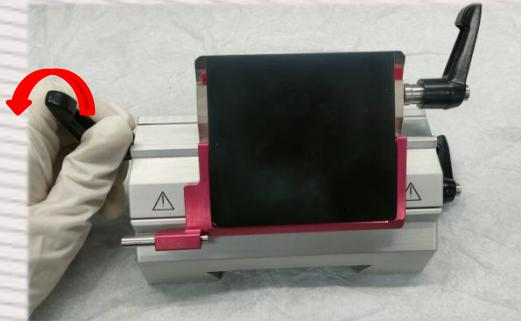
步骤一：朝正面旋转手柄，解锁旋转刀座紧固轴。
